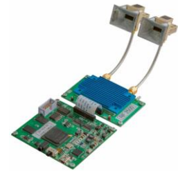
Figure 1. Ancortek SDR-KIT-2500 module [5].
